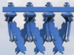
Угол среза относительно почвы 20°, угол наклона первого ряда дисков 16°, угол наклона второго ряда 14° относительно направле- ния движения
